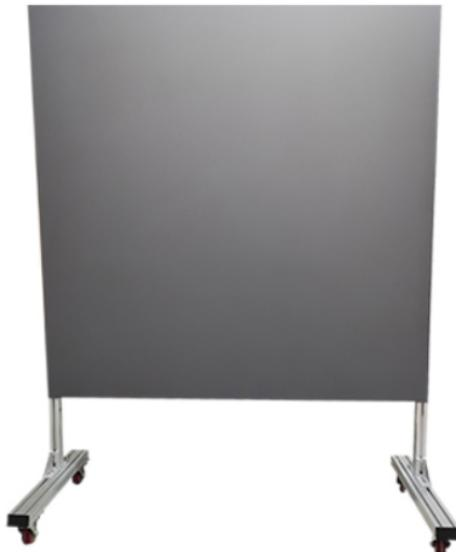
激光雷达定标板有哪些应用领域？① 无人驾驶距离 amp; 标识测试；② 激光测距标准板；③ 环光源均匀性分布测试；④ 激光目标板；⑤ 相机均匀性测试；⑥ 光学反射器；⑦ 激光目标定位；⑧ 遥感目标；⑨ 背光照明；⑩ 模拟靶标……通过匹配两个激光雷达之间的点云，获得两个激光雷达之间的转换关系，从而完成激光雷达到激光雷达的校准。在实际校准过程中，主激光雷达一般先校准，然后校准其他激光雷达到主激光雷达之间的坐标转换关系。瑞科光电拥有专业垂直领域的客户服务团队，专业技术团队为您解答售前和售后技术问题，让您真正享受到购买产品而无后顾之忧。选购激光雷达定标板可以观察哪些方面？防水耐用激光雷达测试板优点
